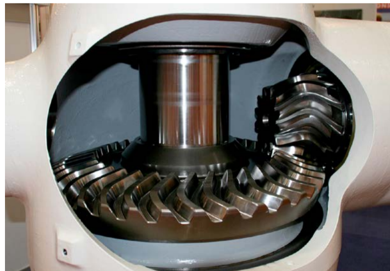
Bierens toonde de nieuwe S-vertanding voor het eerst op de maritieme beurs SMM in Hamburg in deze opengewerkte thruster.
